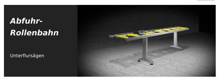
Gestell aus Strahlrohr mit verstellbaren Füßen und Tragrollen aus Stahl mit PVCBezug. Bei 240 mm Rollen beträgt die Länge der Rollenbahn 3.500 mm, bei 440 mm Rollen 4.000 mm.
