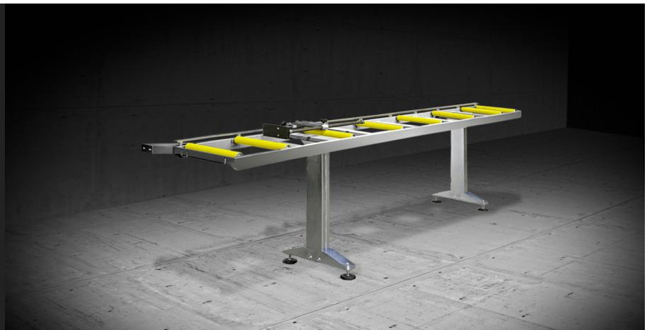
Gestell aus Strahlrohr mit verstellbaren Füßen und Tragrollen aus Stahl mit PVCBezug. Bei 240 mm Rollen beträgt die Länge der Rollenbahn 3.500 mm, bei 440 mm Rollen 4.000 mm.
