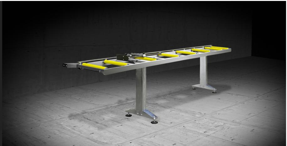
Gestell aus Strahlrohr mit verstellbaren Füßen und Tragrollen aus Stahl mit PVCBezug. Bei 240 mm Rollen beträgt die Länge der Rollenbahn 3.500 mm, bei 440 mm Rollen 4.000 mm.
