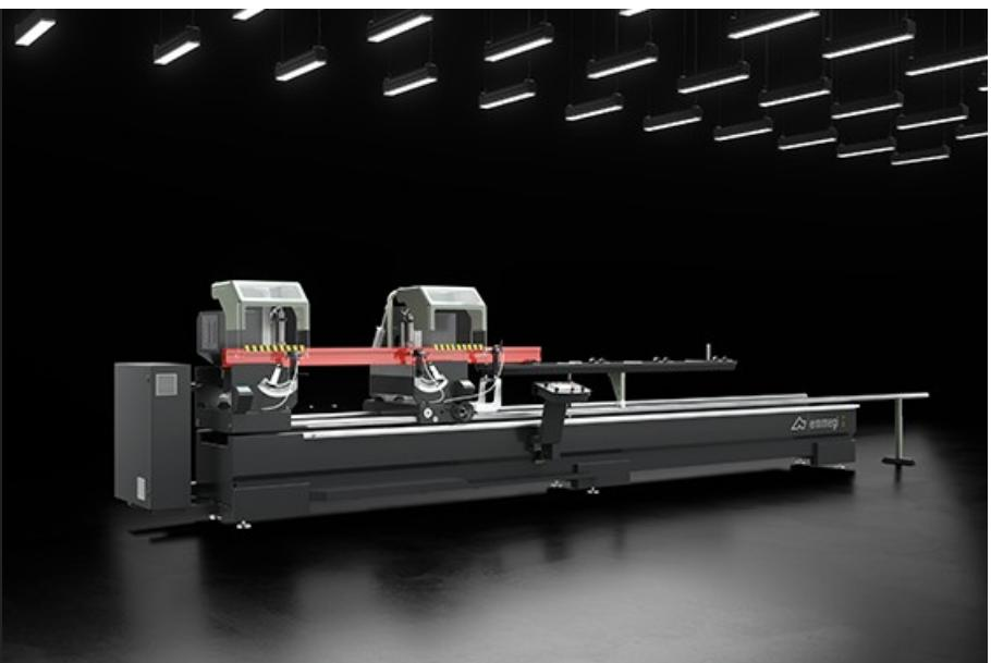
Doppelgehrungssäge mit automatischer Verfahrbewegung des beweglichen Sägeaggregats über Brushless-Motor und CNC gesteuert. Pneumatisch gesteuerte Neigung des Sägeaggregats auf 3 festgelegte Positionen von 90°, 45° und 22° 30' (außen) oder mit mechanischem System für die manuelle Einstellung der Zwischenwinkel. Hydropneumatischer Sägeblattvorschub.
