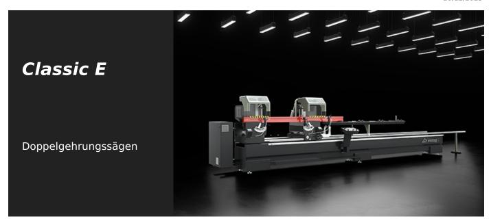
Doppelgehrungssäge mit automatischer Verfahrbewegung des beweglichen Sägeaggregats über Brushless-Motor und CNC gesteuert. Pneumatisch gesteuerte Neigung des Sägeaggregats auf 3 festgelegte Positionen von 90°, 45° und 22° 30' (außen) oder mit mechanischem System für die manuelle Einstellung der Zwischenwinkel. Hydropneumatischer Sägeblattvorschub.
