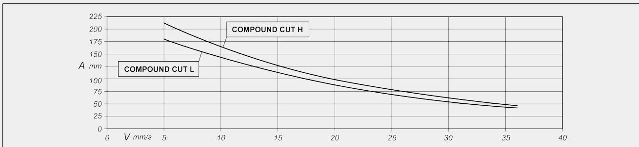
A = Kontaktbogen (mm)      V = Vorschubgeschwindigkeit des Sägeblatts (mm/s)
