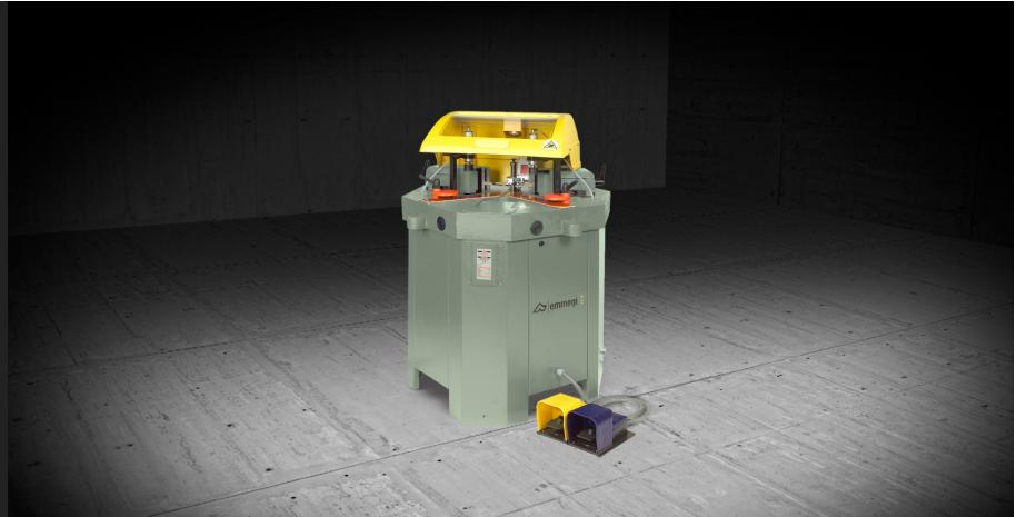
Eckenpresse zur Verbindung von Gehrungen für Türen, Fenster und Fassadenprofile. Einfache Einstellung dank der Verschiebung der Stanzeinheiten. Messerblöcke mit Schnellkupplung und Magneten zur Vermeidung des Herabfallens. Mit digitaler Erfassung der Verschiebung der Fräsköpfe und der Bezugsgabel der Profile. Erleichterte Einstellung durch Ablesbarkeit des Wertes am Displays.
