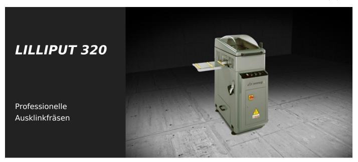
Horizontale Ausklinkfräse mit elektropneumatischem Vorschub. Nicht rechtwinklige Fräsebearbeitung +45° / 90° / -45°. Drehgeschwindigkeit vom Werkzeug zur Verbesserung der Verarbeitungsqualität an lackierten und nicht rechtwinkligen Profilen. Pneumatische Schnellwechselvorrichtung der Fräseinheit. Kratzfester Arbeitstisch. Schallgedämmter Arbeitsbereich mit Vollumhausung.
