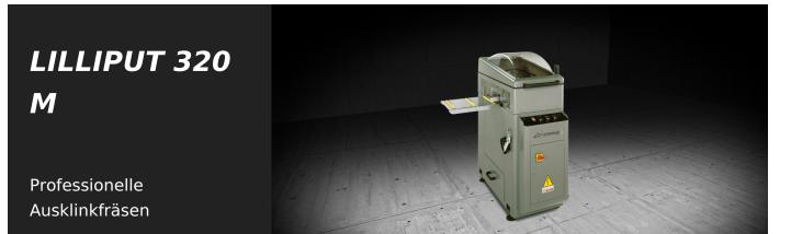
Horizontale Ausklinkfräse mit manuellem Vorschub. Nicht rechtwinklige Fräsebearbeitung +45° / 90° / -45°. Hohe Drehgeschwindigkeit vom Werkzeug zur Verbesserung der Verarbeitungsqualität an lackierten und nicht rechtwinkligen Profilen. Pneumatische Schnellwechselvorrichtung der Fräseinheit. Kratzfester Arbeitstisch und Arbeitsbereich mit Vollumhausung.
