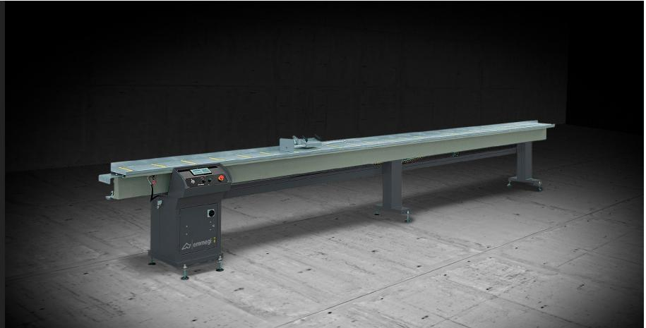
Anschlagsystem für die Profilmessung und -auflage mit durch Wechselstrommotor bewegten Anschlag und elektronischer Erfassung mittels Encoders.
