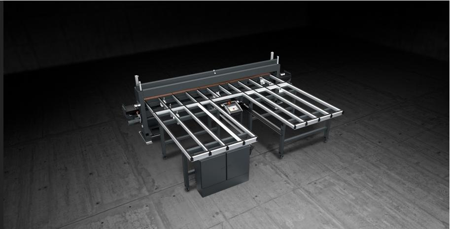
MOD-END RIFILA ist eine halbautomatische Beschneidemaschine mit zwei gesteuerten Achsen für PVC-Rahmen. Sie ist mit einer NC-gesteuerten Schneideeinheit mit einstellbarer Vorschubgeschwindigkeit ausgerüstet.
