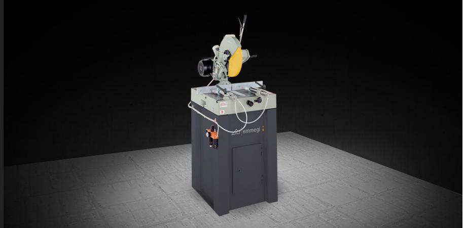
Gehrungssäge mit von oben kommendem Sägeblatt, Zufahrtsseite links, Drehung der Schneideeinheit um 45° (rechts und links) und manuelle Drehung um 45° auf die horizontale Achse möglich.
