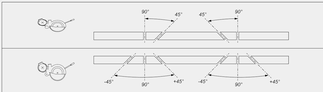
Mechanische Einstellung der Zwischenwinkel
