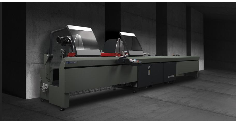
Elektronische Doppelgehrungssäge mit mittels NC-gesteuertem Brushless-Motor automatisch verfahrbarem Sägeaggregat. Pneumatisches Neigen der Schneideeinheiten von 90° bis 22°30' (außen) mit mechanischem System zur Einstellung der dazwischen liegenden Gehrungswinkel. Hydropneumatischer Sägeblattvorschub.
