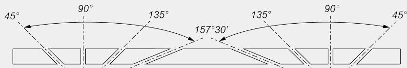
Elektronische Einstellung der Zwischenwinkel
