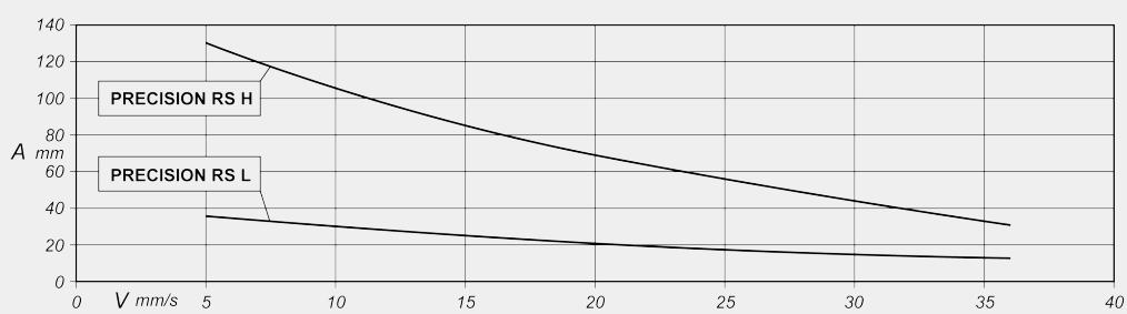
A = Kontaktbogen (mm)      V = Vorschubgeschwindigkeit des Sägeblatts (mm/s)
