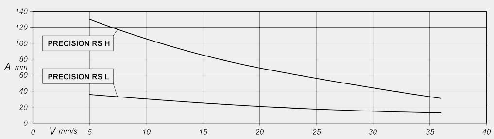
A = Kontaktbogen (mm)      V = Vorschubgeschwindigkeit des Sägeblatts (mm/s)
