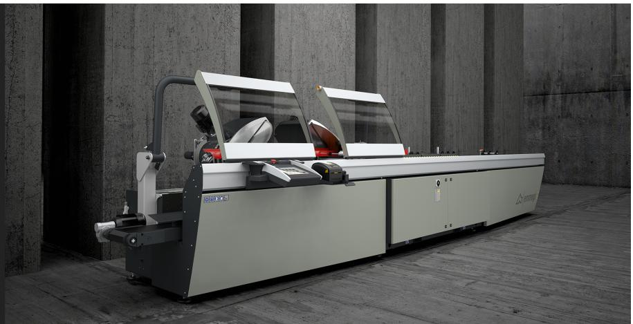
Doppelgehrungssäge mit 3 CNC-gesteuerten Achsen mit automatisch verfahrbarem Kopf und elektronischer Steuerung aller Gehrungen von 45° (innen) bis 15° (außen) mit einer Genauigkeit von 280 Zwischenpositionen pro Grad. Der Sägeblattvorschub wird über ein Paar ölpneumatischer Zylinder gesteuert.
