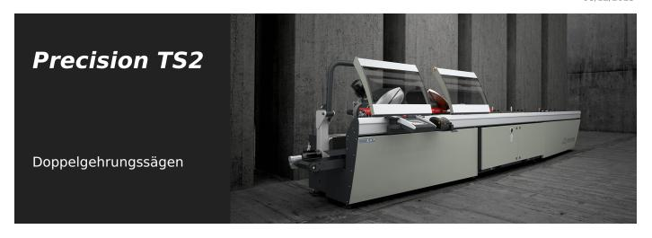
Doppelgehrungssäge mit 3 CNC-gesteuerten Achsen mit automatisch verfahrbarem Kopf und elektronischer Steuerung aller Gehrungen von 45° (innen) bis 15° (außen) mit einer Genauigkeit von 280 Zwischenpositionen pro Grad. Der Sägeblattvorschub wird über ein Paar ölpneumatischer Zylinder gesteuert.
