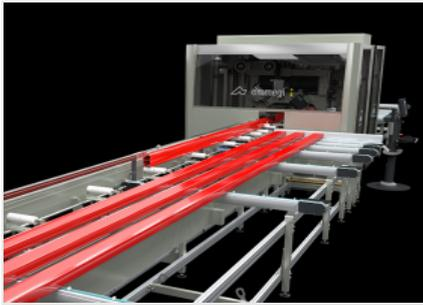
**Stabbeschickung und automatisches Entladen der Werkstücke**
