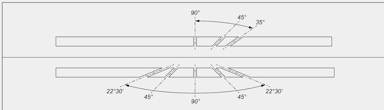
Elektronische Einstellung der Zwischenwinkel auf vertikaler Achse
