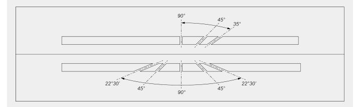
Elektronische Einstellung der Zwischenwinkel auf vertikaler Achse Mechanische Einstellung der Zwischenwinkel auf horizontaler Achse
