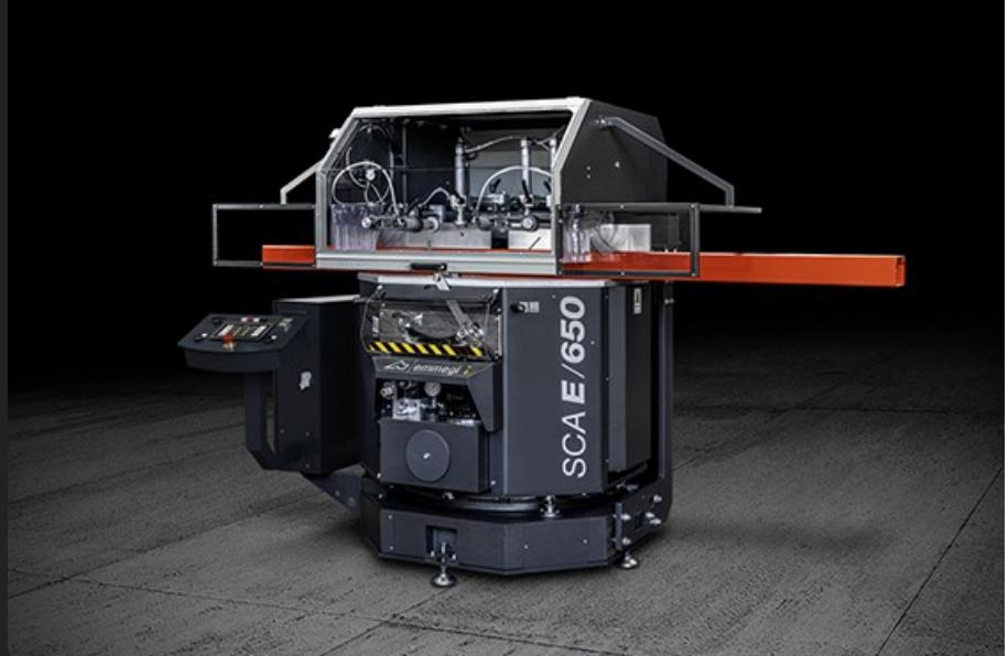
Schifterschnittsäge mit von unten kommendem Sägeblatt und automatischer CNC-gesteuerter Drehung um die vertikale Achse über Gleichstrommotor mit gleichzeitiger hydraulischer Drehung um die horizontale Achse. Gehrungsschnitte von 90° bis 22°30' (links und rechts) auf der vertikalen Achse und von 90° bis 35° (nur rechts) auf der horizontalen Achse (nur rechts).
