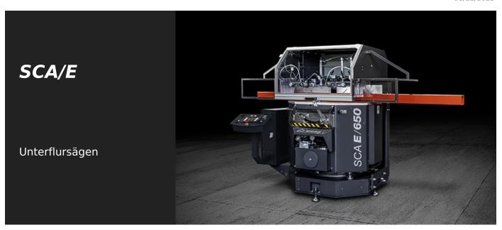
Schifterschnittsäge mit von unten kommendem Sägeblatt und automatischer CNC-gesteuerter Drehung um die vertikale Achse über Gleichstrommotor mit gleichzeitiger hydraulischer Drehung um die horizontale Achse. Gehrungsschnitte von 90° bis 22°30′ (links und rechts) auf der vertikalen Achse und von 90° bis 35° (nur rechts) auf der horizontalen Achse (nur rechts).
