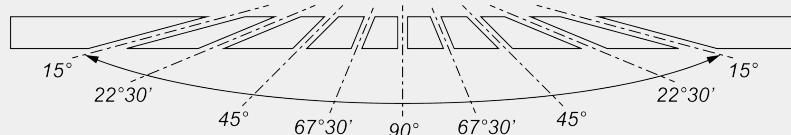
Mechanische Einstellung der Zwischenwinkel
