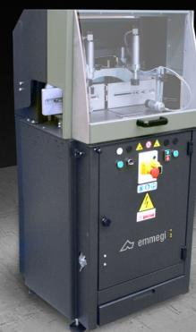
Einkopfsäge mit von unten kommendem, bewegtem Sägeblatt, Zufahrseite links für 15° Gehrungen links bis 15° Gehrungen rechts und Zwischengehrungen.
