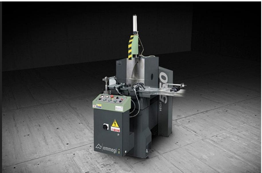
Gehrungssäge mit nach vorne ausfahrendem Sägeblatt, Zufahrseite links; horizontales pneumatisches Schwenken auf feste Gehrungswinkel: links 45° und 90°, rechts 45° und 22°30'. Ein spezieller mechanischer Anschlag ermöglicht auch das Schneiden von Zwischengehrungen.
