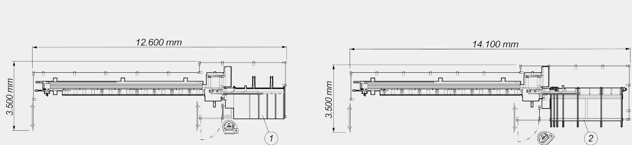
1. Entlademagazin mit automatischer Entnahmeeinrichtung (Standard)
