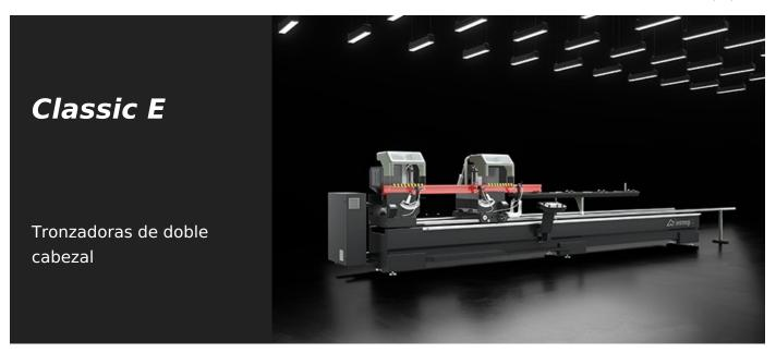
Tronzadora electrónica de doble cabezal con movimiento automático del cabezal móvil, por medio de un motor brushless controlado por un control numérico. Inclinación neumática de los cabezales de corte en 3 posiciones fijas 90°, 45° y 22°30′ (externo) o bien con sistema mecánico de regulación manual de los ángulos intermedios. Avance disco oleoneumático.
