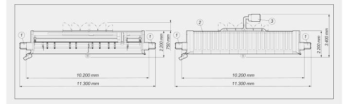
2.590 Altura máquina (extensión máxima eje Z) (mm) Altura máquina con cubierta superior (mm) 2.710
