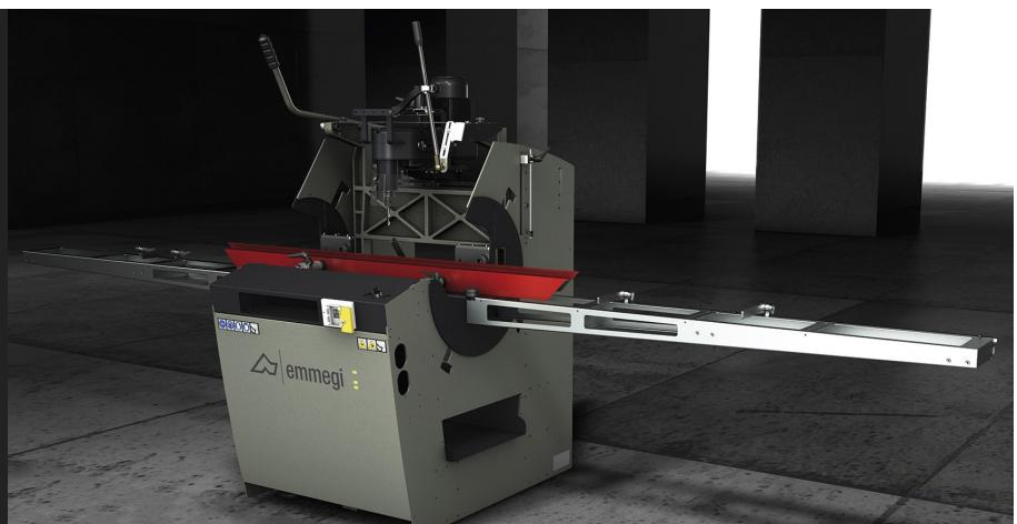
Pantógrafo monocabezal con descenso manual con bloqueo neumático y movimiento de traslación del cabezal mediante la palanca indirecta. Posibilidad de realizar trabajos pasantes en aluminio sin girar la pieza. Plano de trabajo antirayado. Palpador manual.
