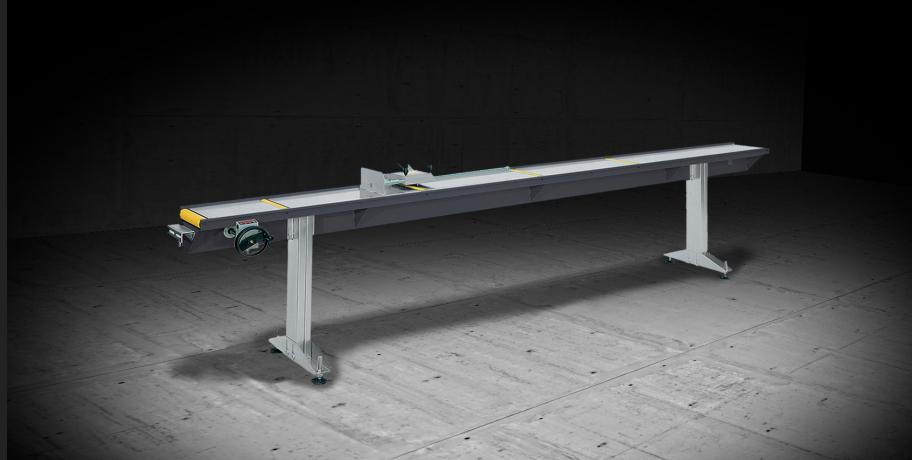
Dispositivo compuesto por tope de medida y soporte del perfil con posicionamiento del mismo tope mediante volante y lectura de la cota en el display digital.
