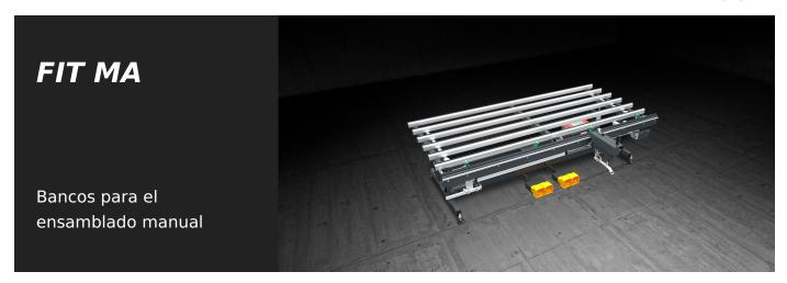
Banco para el ensamblaje de herrajes perimetrales en cinta en hojas de aluminio, madera y PVC. Un sistema de mordazas retráctiles bloquea la hoja. El banco se suministra con un atornillador de alimentación automática y, opcionalmente, de un sistema para la medición y el corte de la herramienta mediante cizalla hidroneumática.
