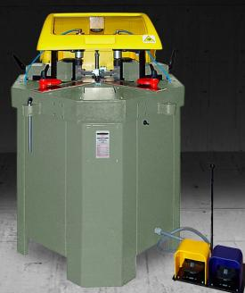
Ensambladora para cerrar ángulos de perfiles de aluminio de todos los tipos. Se regula fácilmente gracias a la translación de las unidades de punzonado. Los bloqueos de los cuchillos están dotados de desenganche rápido e imanes para evitar que caigan. Uso fácil y versatil.
