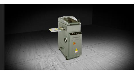
Fresadora retestadora horizontal con avance electroneumático. Fresado fuera escuadra (+45°/90°/-45°). Alta velocidad de rotación de la herramienta: de esta manera, mejora la calidad de mecanizado en el perfil lacado y fuera escuadra. Cambio rápido del grupo de fresado con mando neumático. Plano de apoyo perfil antirrayas. Zona de mecanizado protegida integralmente con gran visibilidad interna.
