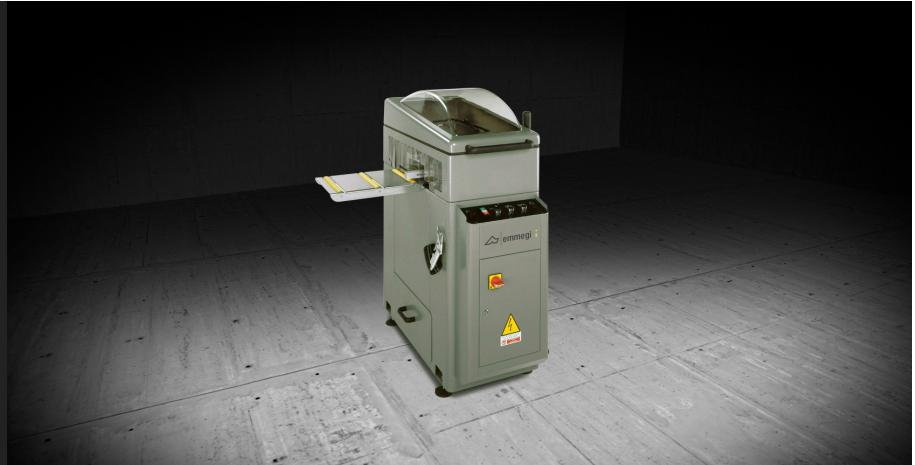
Fresadora retestadora horizontal con avance electroneumático. Fresado fuera escuadra (+45°/90°/-45°). Alta velocidad de rotación de la herramienta: de esta manera, mejora la calidad de mecanizado en el perfil lacado y fuera escuadra. Cambio rápido del grupo de fresado con mando neumático. Plano de apoyo perfil antirrayas. Zona de mecanizado protegida integralmente con gran visibilidad interna.
