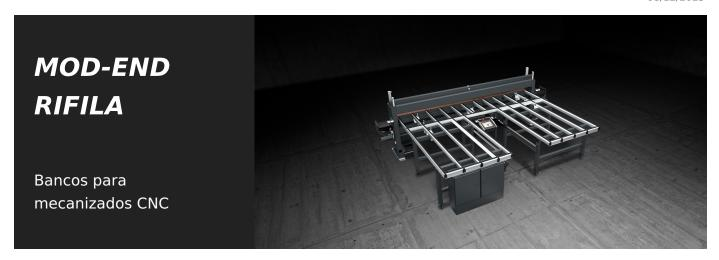
MOD-END RIFILA es una desbarbadora para marcos de PVC con dos ejes controlados de ciclo semiautomático. Posee una unidad de corte CN cuya velocidad de avance es regulable.
