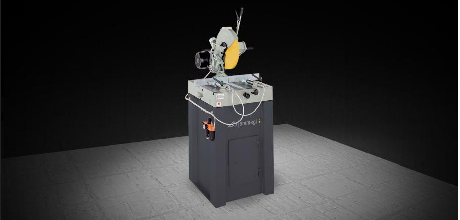
Tronzadora con una unidad de corte descendente, lado izquierdo de carga, rotación de la unidad de corte a 45° (a la derecha y a la izquierda) e inversión manual a 45° respecto al eje horizontal.
