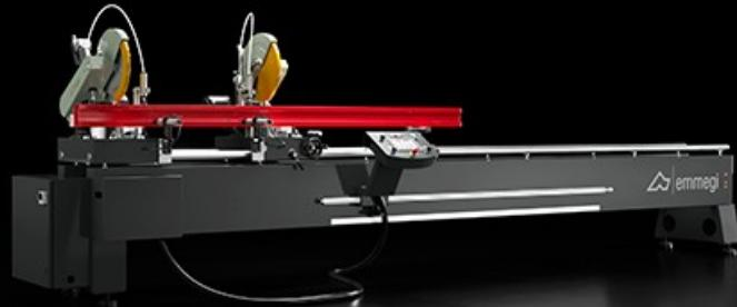
Tronzadora de doble cabezal con movimiento manual del cabezal móvil y detección de la posición por medio de banda magnética absoluta. La rotación de los cabezales de corte sobre el eje vertical (45° a izquierda y derecha) y la inclinación sobre el eje horizontal (45° hacia el interior), con regulación manual, permiten realizar cortes combinados incluso en ángulos intermedios.
