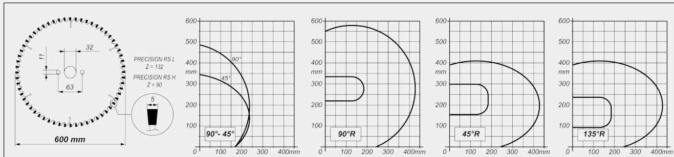
**INCLINACIÓN CABEZAL DE CORTE**
