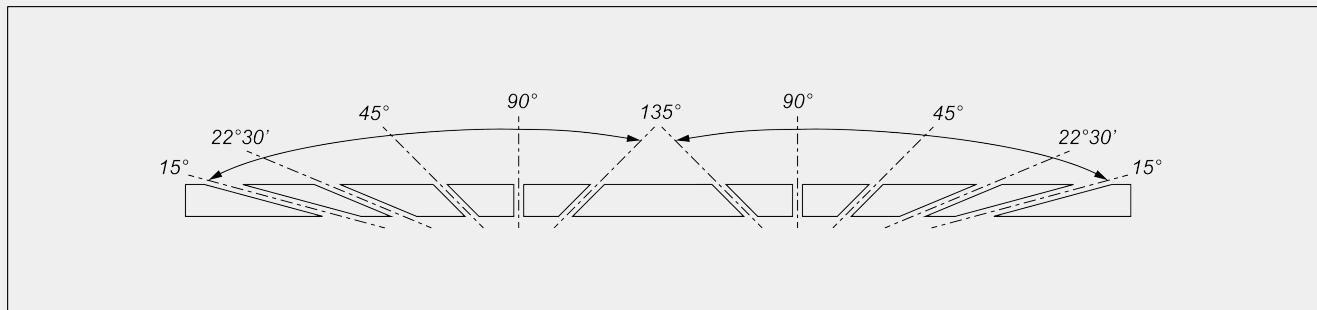
Regulación electrónica de los ángulos intermedios
