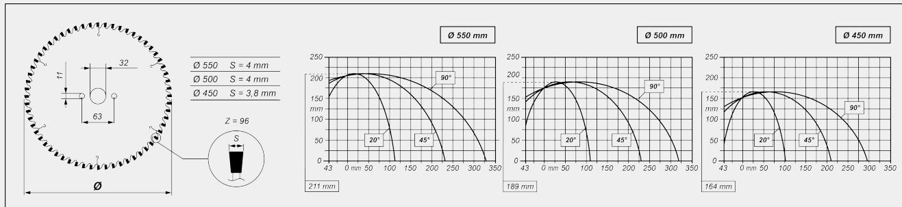
**INCLINACIÓN CABEZAL DE CORTE**
