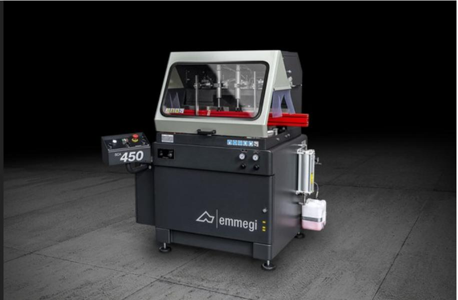
Tronzadora con una unidad de corte ascendente y lado izquierdo de carga. Sirve para efectuar cortes en angulaciones de 20° (a la izquierda) a 20° (a la derecha) y en angulaciones intermedias.
