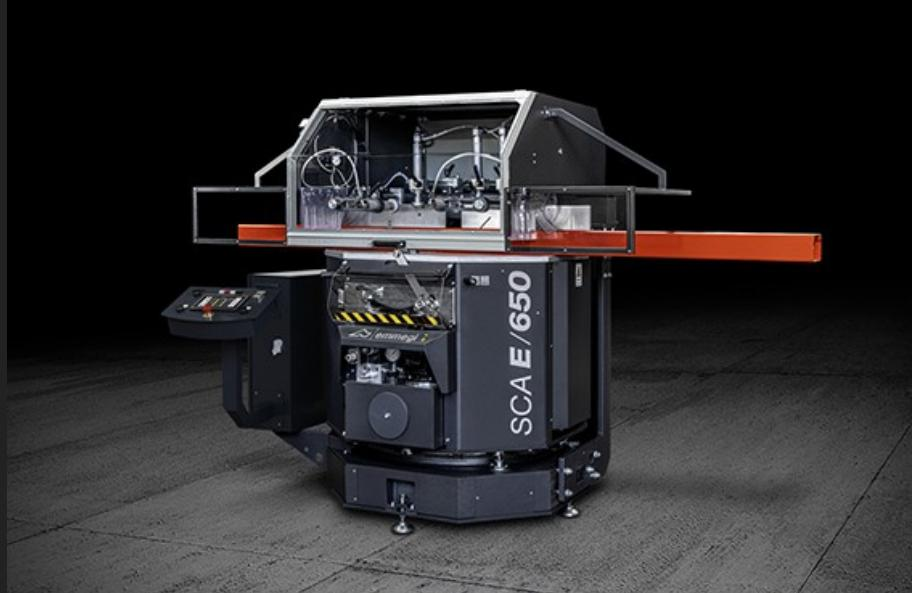
Tronzadora con una unidad de corte ascendente con rotación automática de CN del eje vertical por medio de un motor brushless e inversión simultánea del eje horizontal accionada hidráulicamente. Permite efectuar cortes en angulaciones de 90° a 22°30' (a la izquierda y a la derecha) en el eje vertical y de 90° a 35° (sólo a la derecha) en el eje horizontal.
