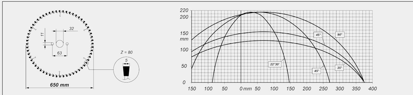
**INCLINACIÓN CABEZAL DE CORTE**
