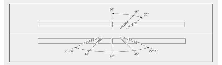
Regulación electrónica de los ángulos intermedios en el eje vertical Regulación mecánica de los ángulos intermedios en el eje horizontal
