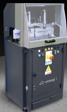
Tronzadora monocabezal con disco ascendente, con lado de carga izquierdo, diseñada para cortar ángulos de 15° a la izquierda y 15° a la derecha, además de ángulos intermedios.
