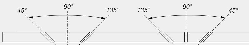
Regulación electrónica de los ángulos intermedios
