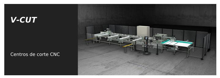
Centro de corte CNC de 3 ejes controlados, completamente automático. Sirve para cortar perfiles de aluminio, PVC y aleaciones ligeras en general. A partir de la barra de perfil extruido, V-CUT carga, corta y descarga automáticamente listas de corte predeterminadas y optimizadas. Sirve también para efectuar cortes en angulaciones desde 45° hasta 135° o bien desde 22°30' hasta 157°30'.
