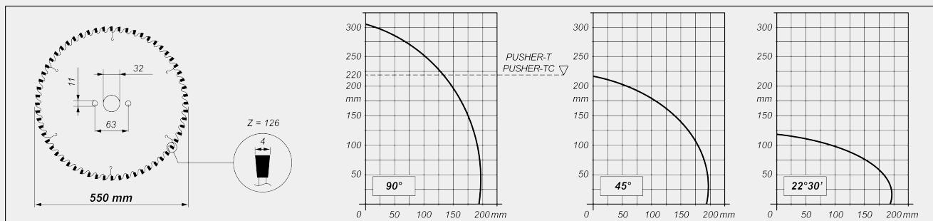
**INCLINACIÓN CABEZAL DE CORTE**
