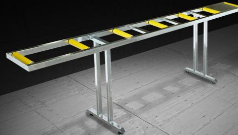
Structure tubulaire en acier munie de pieds réglables: équipée de rouleaux de 240 mm, la longueur du chemin d'aménage atteint 3.500 mm; dotée de rouleaux de 440 mm, sa longueur est de 4.000 mm.
