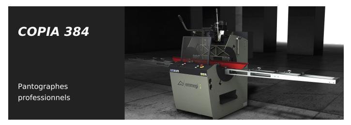
Pantographe à tête simple à commande manuelle avec blocage pneumatique et mouvement de translation de la tête à travers un levier indirect. Vitesse de rotation de l'outil modifiable par variateur électronique pour permettre les usinages sur l'acier jusqu'à 2 mm et pour améliorer la qualité des fraisages et la durée de vie de l'outil. Possibilité d'effectuer des usinages passants sur aluminium sans tourner la pièce. Plan de travail anti-rayure. Palpeur à commande manuelle.
