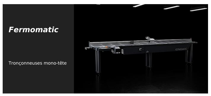
Système de référence mesure et support profil avec mouvement de la butée par moteur sans balais et lecture électronique par bande magnétique absolue. Disponible en trois longueurs avec une grande précision et répétabilité de positionnement.
