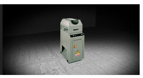
Grugeuse en bout horizontale à avance manuelle. Fraisage en biais à  $+45^{\circ}$  /  $90^{\circ}$  /  $-45^{\circ}$ . Changement rapide du groupe de fraisage assuré par commande pneumatique. Table de travail anti-rayures. Protection intégrale de la zone d'usinage.
