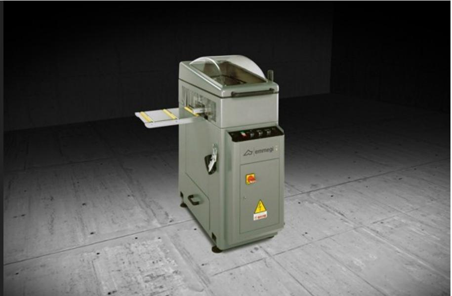
Grugeuse en bout horizontale à avance électropneumatique. Fraisage en biais à +45° / 90° / -45°. Vitesse élevée de rotation de l'outil, 6000 tours/ min., afin d'améliorer la qualité de l'usinage sur les profilés peints et en biais. Changement rapide du groupe de fraisage assuré par commande pneumatique. Table de travail anti-rayures. Zone d'usinage intégralement protégée par un carter et dotée d'une large visibilité intérieure.
