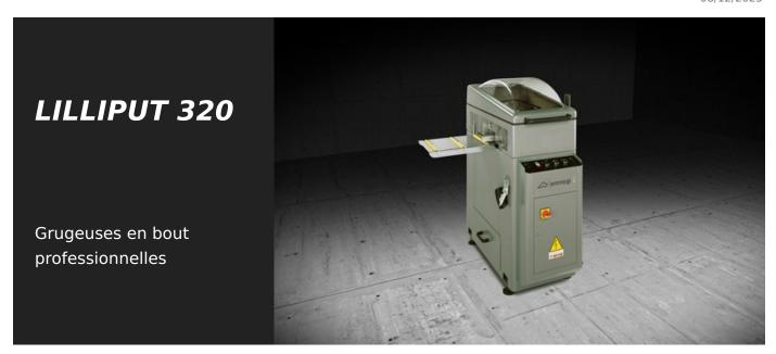
Grugeuse en bout horizontale à avance électropneumatique. Fraisage en biais à +45° / 90° / -45°. Vitesse élevée de rotation de l'outil, 6000 tours/ min., afin d'améliorer la qualité de l'usinage sur les profilés peints et en biais. Changement rapide du groupe de fraisage assuré par commande pneumatique. Table de travail anti-rayures. Zone d'usinage intégralement protégée par un carter et dotée d'une large visibilité intérieure.
