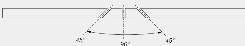
Réglage mécanique des angles intermédiaires
