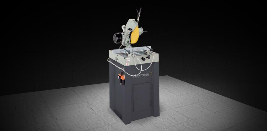
Tronçonneuse simple tête à lame descendante avec côté de chargement sur la gauche, rotation de la tête de sciage à 45° (droite et gauche) et pivotement manuel à 45° par rapport à l'axe horizontal.
