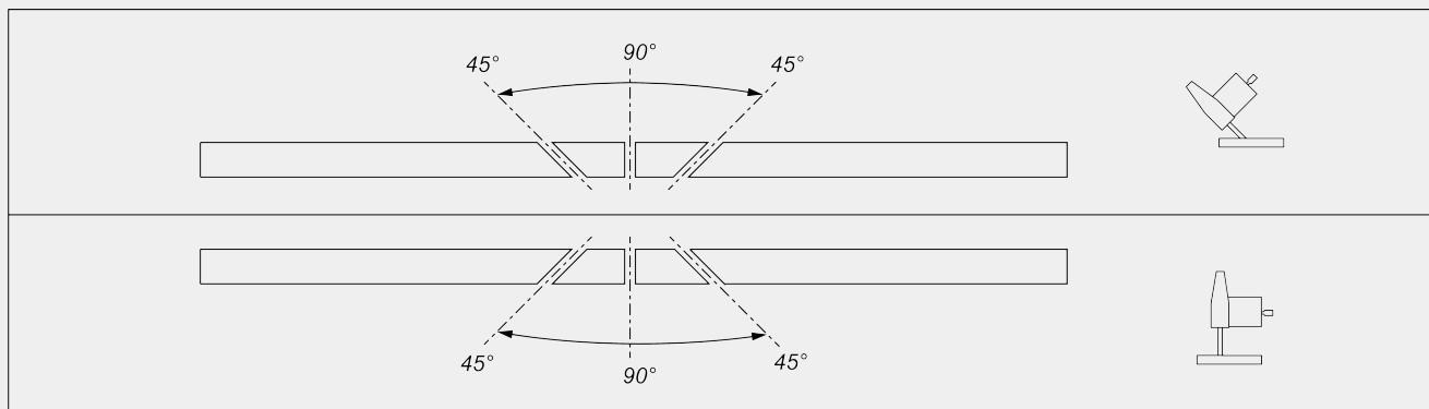
Réglage mécanique des angles intermédiaires
