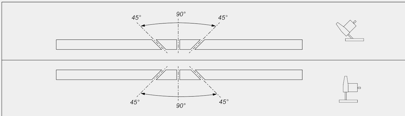
Réglage mécanique des angles intermédiaires
