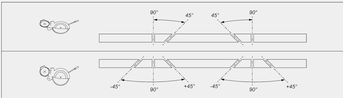
Réglage mécanique des angles intermédiaires
