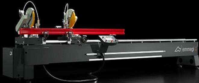
Tronçonneuse double tête avec mouvement manuel de la tête mobile et détection de la position au moyen d'une bande magnétique absolue. La rotation des unités de coupe sur l'axe vertical (45° vers la gauche et vers la droite) et l'inclinaison sur l'axe horizontal (45° internes), avec réglage manuel, permettent de réaliser des coupes débillardées même à des angles intermédiaires.
