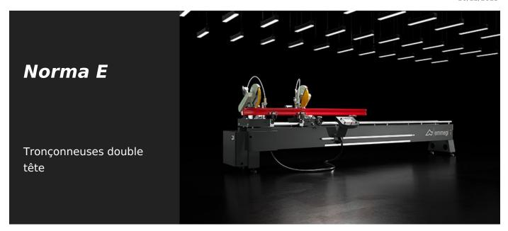
Tronçonneuse double tête avec mouvement manuel de la tête mobile et détection de la position au moyen d'une bande magnétique absolue. La rotation des unités de coupe sur l'axe vertical (45° vers la gauche et vers la droite) et l'inclinaison sur l'axe horizontal (45° internes), avec réglage manuel, permettent de réaliser des coupes débillardées même à des angles intermédiaires.
