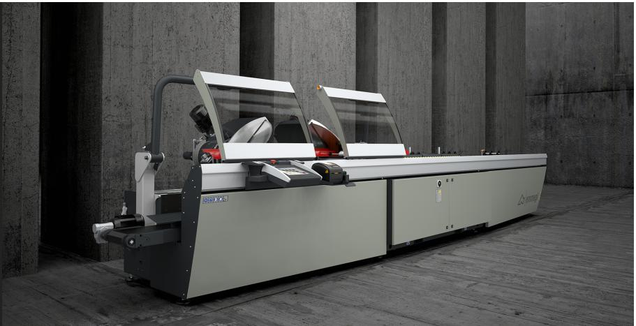
Tronçonneuse double tête à 3 axes contrôlés avec mouvement automatique de la tête mobile et gestion électronique de tous les angles de 45° (internes) à 15° (externes) avec une précision, à l'intérieur de chaque degré, de 280 positions. L'avance de la lame est actionnée par deux cylindres oléopneumatiques.
