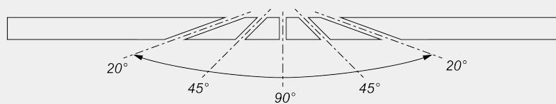
Réglage mécanique des angles intermédiaires
