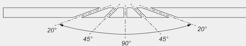
Réglage mécanique des angles intermédiaires
