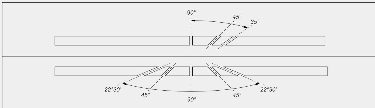
Réglage électronique des angles intermédiaires sur axe vertical
