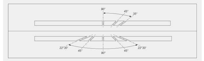
Réglage électronique des angles intermédiaires sur axe vertical Réglage mécanique des angles intermédiaires sur axe horizontal
