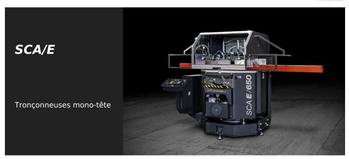
Tronçonneuse simple tête à lame ascendante avec rotation automatique à CN de l'axe vertical au moyen d'un moteur brushless et pivotement simultané de l'axe horizontal par commande hydraulique. Angles de coupe de 90° à 22°30′ (gauche et droite) sur l'axe vertical et de 90° à 35° (uniquement à droite) sur l'axe horizontal.
