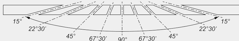
Réglage mécanique des angles intermédiaires
