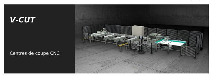
Centre de coupe CNC à 3 axes commandés de manière totalement automatique, conçu pour la coupe de profilés en aluminium, PVC et alliages légers en général. V-CUT part de la barre en profilé extrudé pour effectuer automatiquement le chargement, la coupe et le déchargement de listes de coupe prédéfinies et optimisées. Configuré pour l'exécution de coupes avec des angles compris entre 45° et 135° ou bien entre 22°30' et 157°30'.
